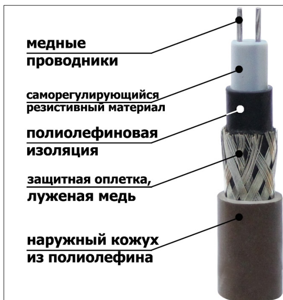
Рис. 25. Конструкция саморегулирующегося термокабеля
